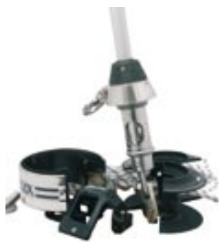
Desmontar el guardacabos, el guía cabos, el cabo y las mitades del tambor
