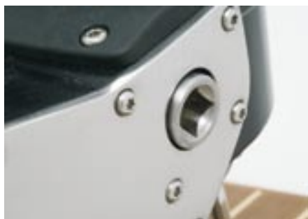
En caso de fallo eléctrico, el FURLEX Eléctrico puede ser accionado manualmente.
